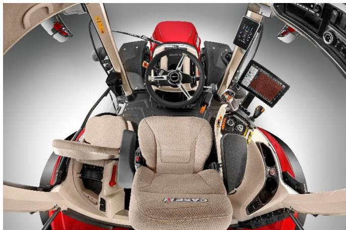
Η προηγμένη σχεδίαση της καμπίνας περιλαμβάνει το επανασχεδιασμένο εργονομικό υποβραχιόνιο Multicontroller, μέσω του οποίου μπορεί κάποιος να διαχειριστεί το 95% των λειτουργιών που χρησιμοποιούνται περισσότερο από τον χειριστή, πολλές από τις οποίες μπορούν να ελεγχθούν είτε μέσω της οθόνης αφής είτε μέσω του νέου ενσωματωμένου επιλογέα κωδικοποιητή turn-and-press. Για απόλυτη άνεση χειρισμού και οδήγησης, μπορεί να επιλεγεί μια προαιρετική νέα ημι-ενεργητική ανάρτηση καμπίνας.
